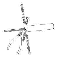
Coloque os fios no alinhador respeitando a cor segundo a norma TIA568A/B.
